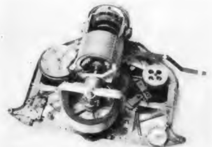
Bild 2. Antriebsmechanismus des AEG-Magnetophons KL 15
