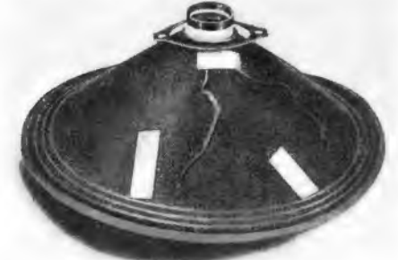
Bild 2. Das Festlegen der Anschlußenden der Schwing-spule und das Kleben von leichten Rissen in der Membrane durch Tesaflexstreifen
