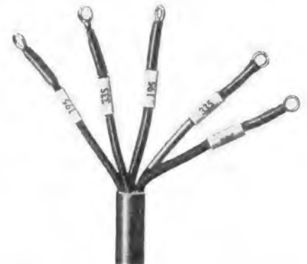
Bild 6. Kennzeichnen von Kabeladern und Kabelschuhen durch Tesadur-Bezeichnungsband
