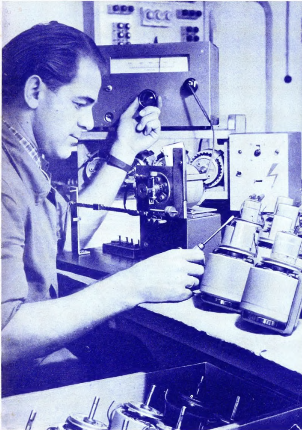
Prüfung der Laufelgenschaften von Motoren für Drahttongeräte. Die Drehzahl wird bei verschiedenen Belastungen stroboskopisch mit der Frequenz eines Tongenerators verglichen. Bei Belastungsschwankungen bis zu 40% darf sich die Drehzahl um höchstens 1% ändern.
