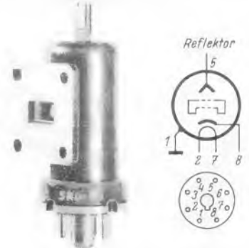
Ansicht und Sockelschaltung des Reflex-Klystrons SRU-55
