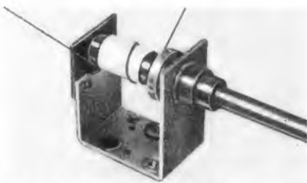
Bild 3. Die Tesaband-Bandage verhindert das Rutschen des Skalenseiles
