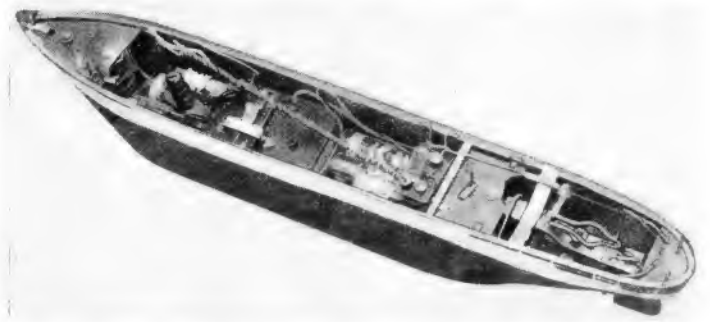
Bild 4. Dieses Modellboot ist nur 30 cm lang und wird von Zivilingenieuren benutzt, um Modellanlagen von Hafeneinrichtungen zu untersuchen. Ein Wahlsystem ermöglicht vier Ruderstellungen mit Hilfe eines gummimotorbetriebenen Schrittschaltgetriebes und läßt Start, Stopp und Drehrichtungsumkehr des Schiffsmotors zu.
