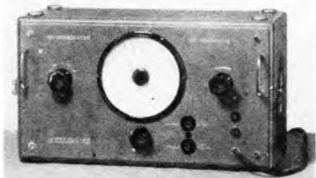
Bild 3. Außenansicht des RC-Summers für 30 bis 300000 Hz. Links Bereichsschalter, Mitte Frequenzvariation 1 : 10, rechts Amplitudenregelung, darunter Netzschalter
