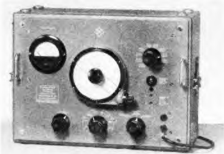
Bild 4. Ansicht des Sinusgenerators für Frequenzen von 20 Hz bis 2 MHz. Es können Spannungen am Ausgang von 5 \mu V bis 5 Volt (bei einem Klirrfaktor von weniger als 0,2%) eingestellt werden
