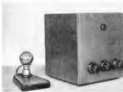
Bild 8. Das betriebsfertige Clipper-Filter. An der Frontplatte befinden sich links der Eingangsregler (1 M \Omega ), in der Mitte der Umschalter S 1 und rechts das Ausgangspotentiometer (2 k \Omega )
