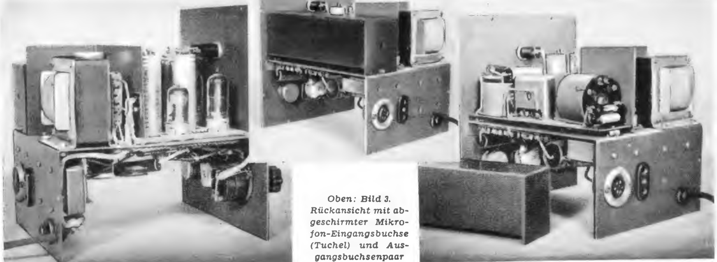
Unten: Bild 2. Seitenansicht des Clipper-Filters mit Netzteil
