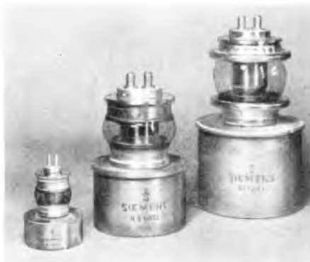
Luftgekühlte Siemens-UKW-Senderöhren RS 1021 L, RS 1001 L und RS 1031 L (von links nach rechts), wie sie in Fernsehsendern Verwendung finden
