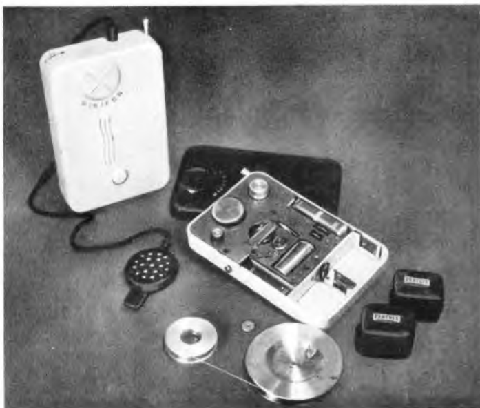
Ontraskop 3 mit Bereichs-Tastenwähler. Links: Das „Minofon“ Tonaufnahme- und Wiedergabegerät im Taschenformat für Batteriebetrieb
