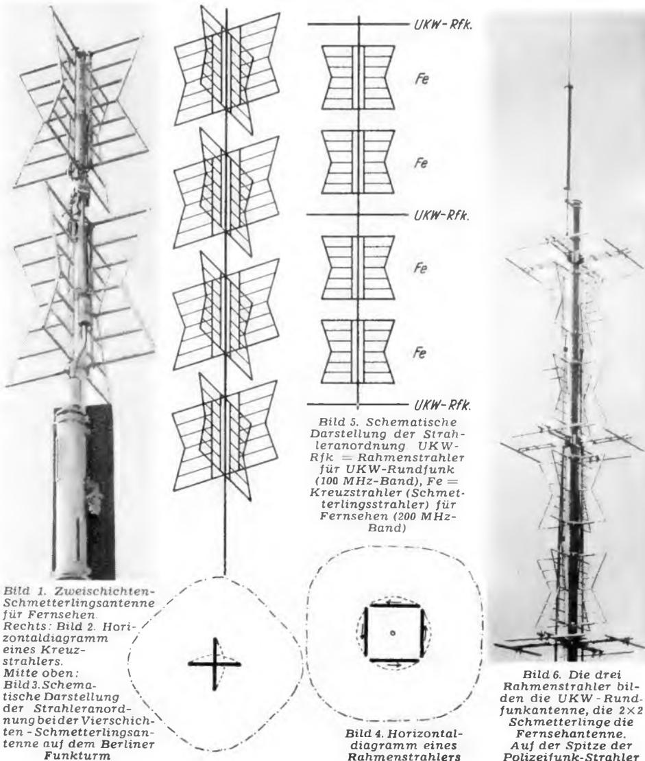
Bild 1. Zweischichten-Schmetterlingsantenne für Fernsehen. Rechts: Bild 2. Horizontaldiagramm eines Kreuzstrahlers. Mitte oben: Bild 3. Schematische Darstellung der Strahleranordnung bei der Vierschichten-Schmetterlingsantenne auf dem Berliner Funkturm
