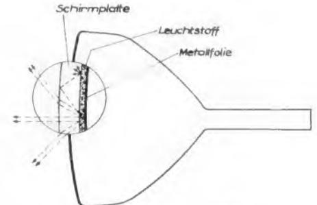
Bild 2. Metallisierte Bildröhre, verbesserte Lichtverteilung deutlich sichtbar
