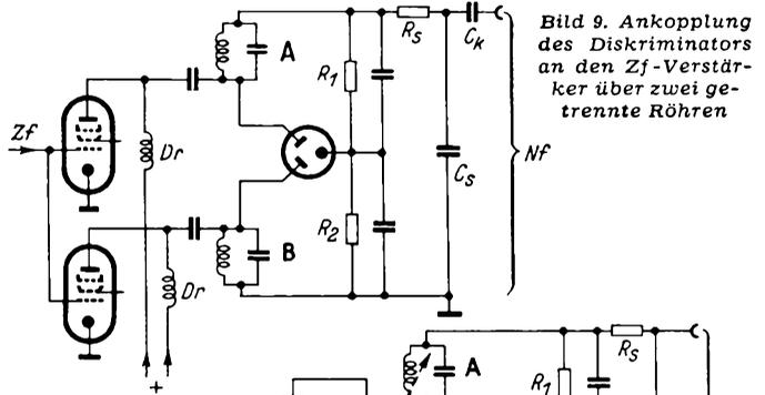
Bild 9. Ankopplung des Diskriminators an den Zf-Verstärker über zwei getrennte Röhren
