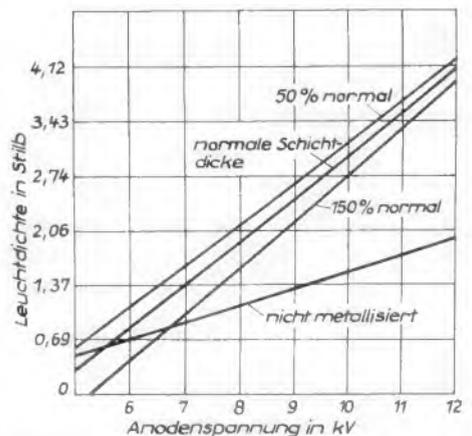
Bild 4. Leuchtdichte von 35-cm-Rechteck-Bildröhren mit verschieden starker Aluminiumierung
