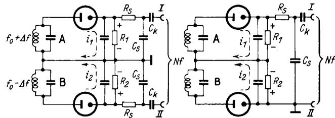
Bild 4. Prinzipschaltbild des Gegentaktdiskriminators, Nf-Ausgang symmetrisch gegen Erde
