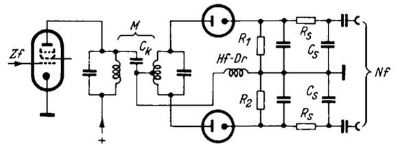
Bild 14. Phasendiskriminatorschaltung. Symmetrischer Nf-Ausgang, Duodiode mit getrennten Katoden
