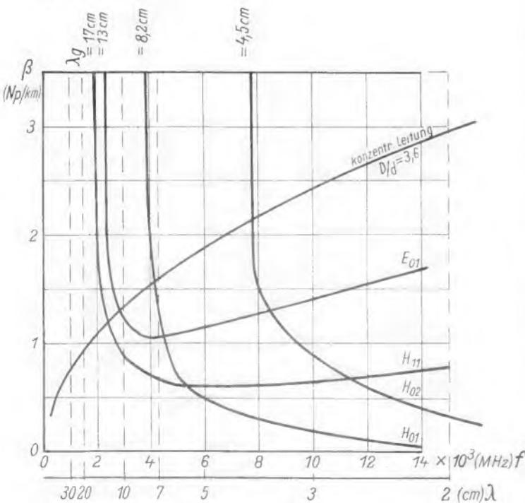
Bild 4. Die Dämpfung im Hohlleiter ( $D=10\text{ cm}$ ) für verschiedene Hohlrohrschwingungen im Vergleich zur Dämpfung einer konzentrierten Leitung mit  $D/d = 3,6$ . (Hohlrohr aus Kupfer, Dielektrikum Luft)
