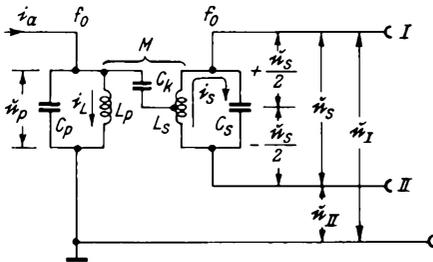
Bild 11a. Prinzipschaltbild des Phasendiskriminators (Foster-Seeley-Diskriminator)
