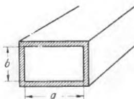
Bild 2. Hohlleiter mit rechteckigem Querschnitt
