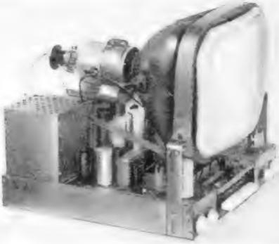
Chassis-Seitenansicht des Grundig-Fernsehempfängers
