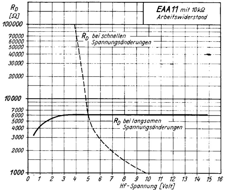
Bild 18 b. Dämpfungswiderstand  $R_D$  einer Diodenstrecke der EAA 11 bei einem Arbeitswiderstand von  $10 k\Omega$  in Abhängigkeit von der Hf-Wechselspannung. Ausgezogene Kurve: bei konstanter Wechselspannung oder langsamen Änderungen. Gestrichelte Kurve: bei schnellen Änderungen
