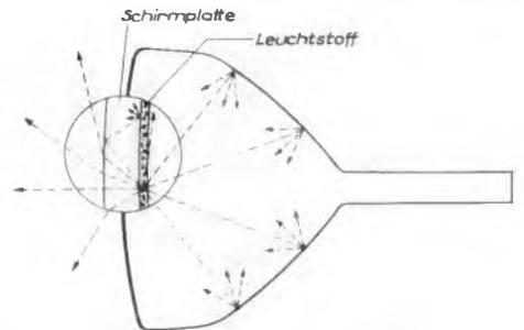
Bild 1. Nichtmetallisierte Bildröhre. Lichtverteilung von einem Lichtfleck
