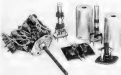
Verschiedene „Hoboton“-Radioteile (Von links nach rechts: Spulenaggregat, Zf-Filter für 468 kHz, Zf-Filter für 10,7 MHz; davor: Doppelsperrkreis für 10,7 MHz, Sperrkreis für das 80-m-Band)
