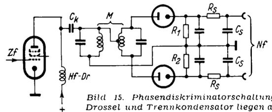
Bild 15. Phasendiskriminatorschaltung, Drossel und Trennkondensator liegen an anderer Stelle
