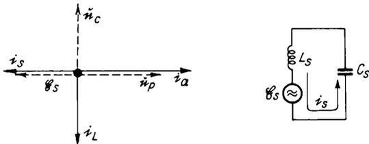
Bild 11b, c. Diagramme zur Erläuterung der Phasenverschiebung von  $90^\circ$  bei einem Bandfilter
