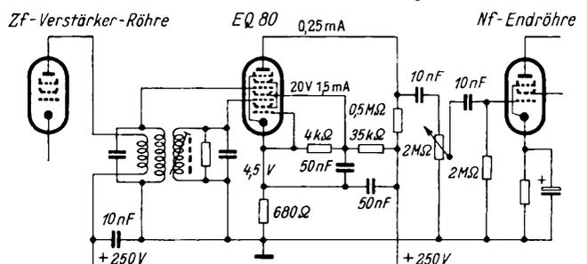
Bild 30. Vollständige Schaltung einer Diskriminatorstufe mit Phasenwinkel-detektorröhre
