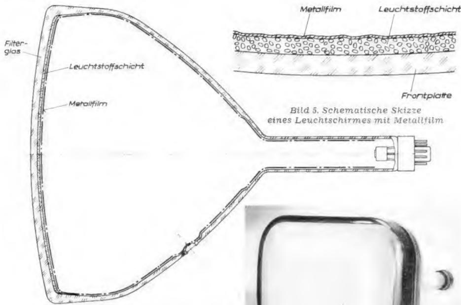
Bild 5. Schematische Skizze eines Leuchtschirms mit Metallfilm
