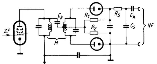
Bild 16. Phasendiskriminatorschaltung. Hf-Drossel ist eingesparrt: Nf-Ausgang unsymmetrisch (Armstrongschaltung)
