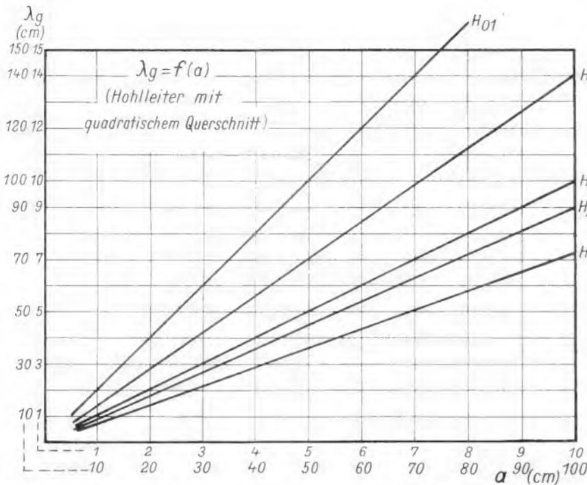
Bild 3. Die Grenzwellenlänge in einem Hohlleiter mit quadratischem Querschnitt für verschiedene Schwingungsformen
