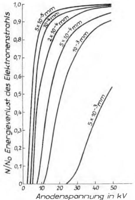
Bild 3. Energieverlust des Elektronenstrahls beim Durchgang durch Aluminiumfolien
