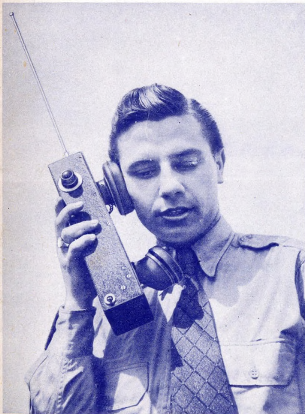
Handfunktelefon für den 2-m-Amateurbereich, das von Mitgliedern des Radio-Klub München in Gemeinschaftsarbeit entwickelt wurde. Als Rekord wurden sendemäßig 7 km, in Empfängerschaltung 113 km überbrückt. (Aufnahme: Carl Stumpf)
