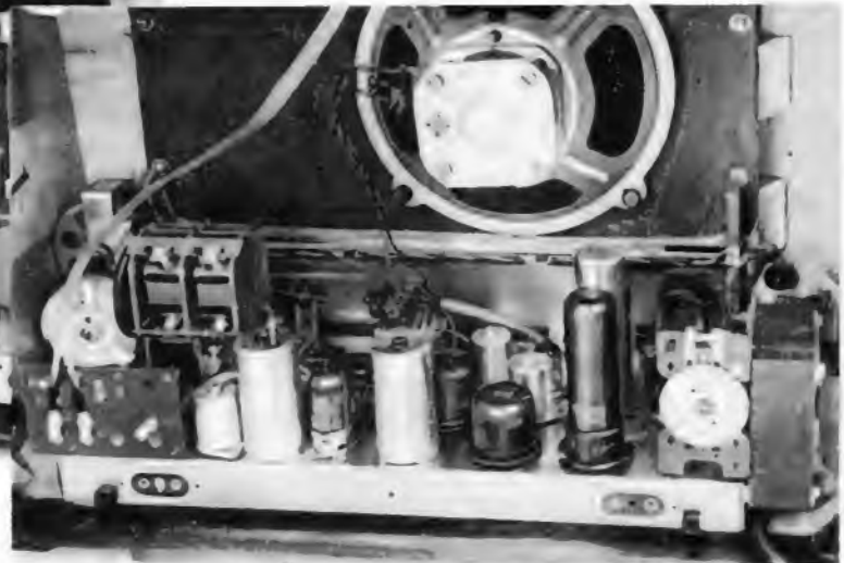
Charakteristisch für die Innenausstattung zahlreicher AM-FM-Superhets ist der Einbau einer UKW-Innenantenne, die auch der Telefunken 7/8-Kreis-Super „Operette 52“ verwendet. Das Bild zeigt allerdings nur die Zuleitung
