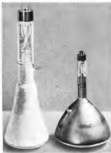
Bild 63. Ansicht einer älteren und einer modernen Fernsehrohr
