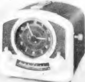
Links: Großsuper „Nürnberg“, ein 9-Kreis-8-Röhrengerät mit Drucktastenabstimmung, Magischem Auge, Trommelskala und 7 Wellenbereichen
