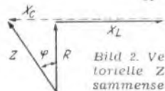
Bild 2. Vektorielle Zusammensetzung der Widerstandswerte im Hinblick auf das Stromspannungsdiagramm
