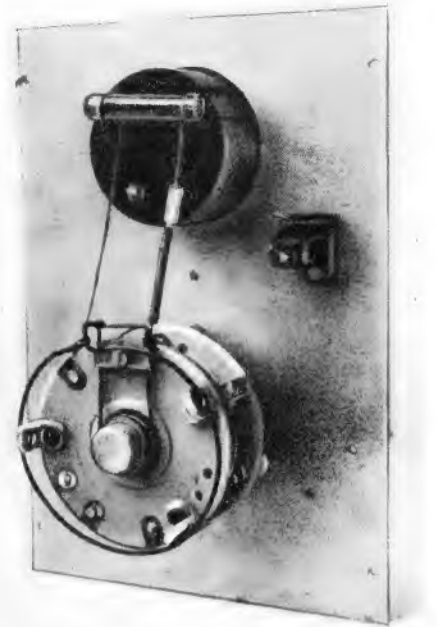
Bild 3. Aufbau des einfachen UKW-Absorptionsfrequenzmessers
