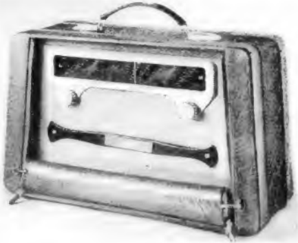
Der 6-Kreis-5-Röhrensuper Lembeck-„Kamerad“ gehört in die Reihe der Vorstufensuperhets
