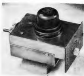
UKW-Einsteckteil mit Röhrensockel (Nora)
