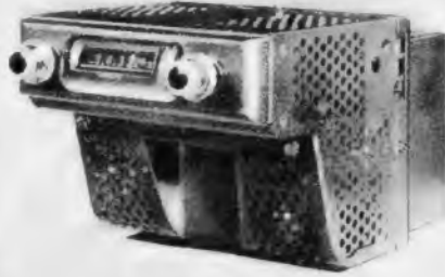
Trommelskala und eine leicht aufschraubbare Metallklappe sind kennzeichnend für den fortschrittlichen Aufbau des Philips-Autosuperhets ND 593 V
