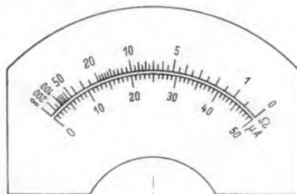
Bild 112. Skala des Ohmmeters nach Schaltung Bild 111
