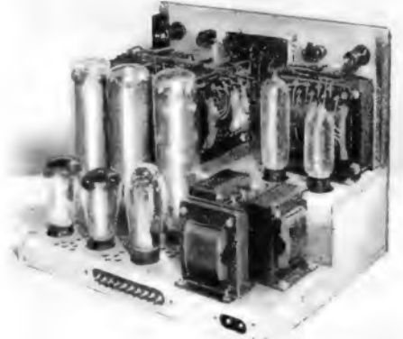
Innenansicht des Gerätes nach Schaltung D. Die Röhren befinden sich aus Entlüftungsgründen auf einer versenkt angeordneten Platte
