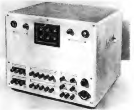
Ansicht des eingebauten Gerätes nach Schaltung D. In der Mitte oben, hinter einer abnehmbaren Plexiglastafel, befinden sich die Glühlämpchen-Sicherungen zum Schutz der Transformatoren gegen Heizfaden-Anoden-Schluß
