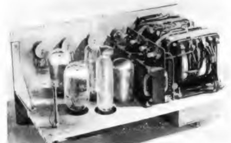
Rückansicht des Gleichrichters nach Schaltung C
