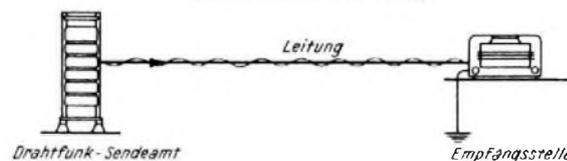
Bild 1. Schema der drahtlosen Rundfunkübertragung und der Drahtfunkübertragung
