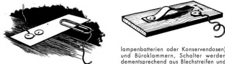
lambenbatterien oder Konservendosen) und Büroklammern, Schalter werden dementsprechend aus Blechstreifen und Reißzwecken auf Holzplättchen gebaut.
