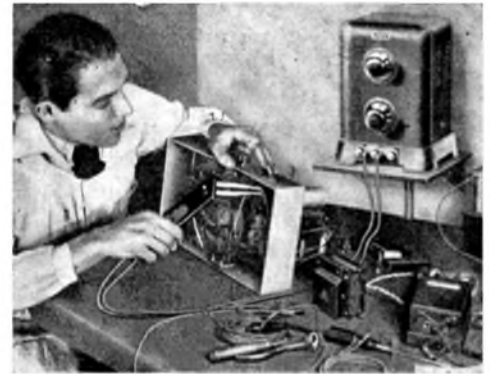
Bild 1. AEG-Kleinschweißzange mit zugehörigem Netzgerät im Gebrauch.
