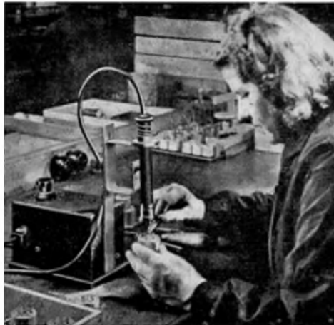
Bild 6. Für die Massenfertigung läßt sich der Schweißgriffel in einen an das Netzgerät angebaute Halter einspannen.
