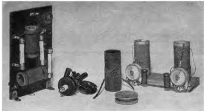
Bild 4. Hier sehen wir alle in Betracht kommenden Spulen versammelt: Ganz links ein Ausführungsbeispiel für die sehr zuverlässige, aber verhältnismäßig viel Platz beanspruchende Form des Eingangsfilters nach Schaltbild 2 in Heft 7/1941, S. 109, dieser Zeitschrift, daneben das gedrängt aufgebaute Original-Allei-Eingangsfilter, vor demselben eine unbewickelte Holzspule zur Selbstanfertigung ähnlicher Filter, rechts anschließend eine zylindrische Oszillatorspule für 500-cm-Drehkondensator, ganz rechts das neue Selbstbau-Zf-Filter.
