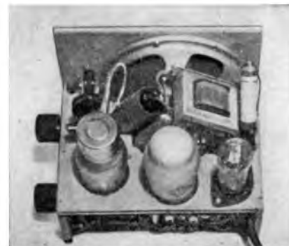
Innenansicht des kleinen Allstromempfängers
