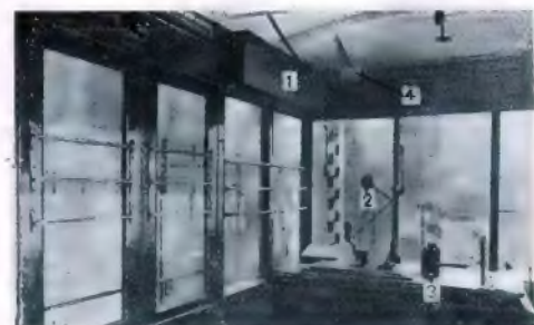
Bild 3. Triebwagen, Führerstand. 1 Schaltkästen für Verstärker u. Stromversorgung, 2 Mikrofon, 3 Druckknopf, 4 Schalter und Sicherung.
