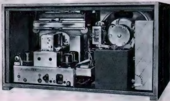
Bild 8. Batteriefuper (Heimgerät) mit eingebauten Batterien (Mende-Super 250 B).
