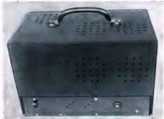
Der fertige Verstärker ist mit einer gelochten Eisenblechhaube abgedeckt u. mit Hilfe eines Griffes leicht tragbar.
