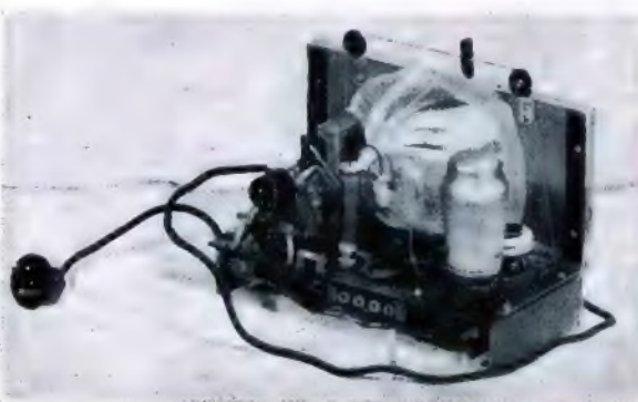
Der umgebaute DKE-Empfänger.
