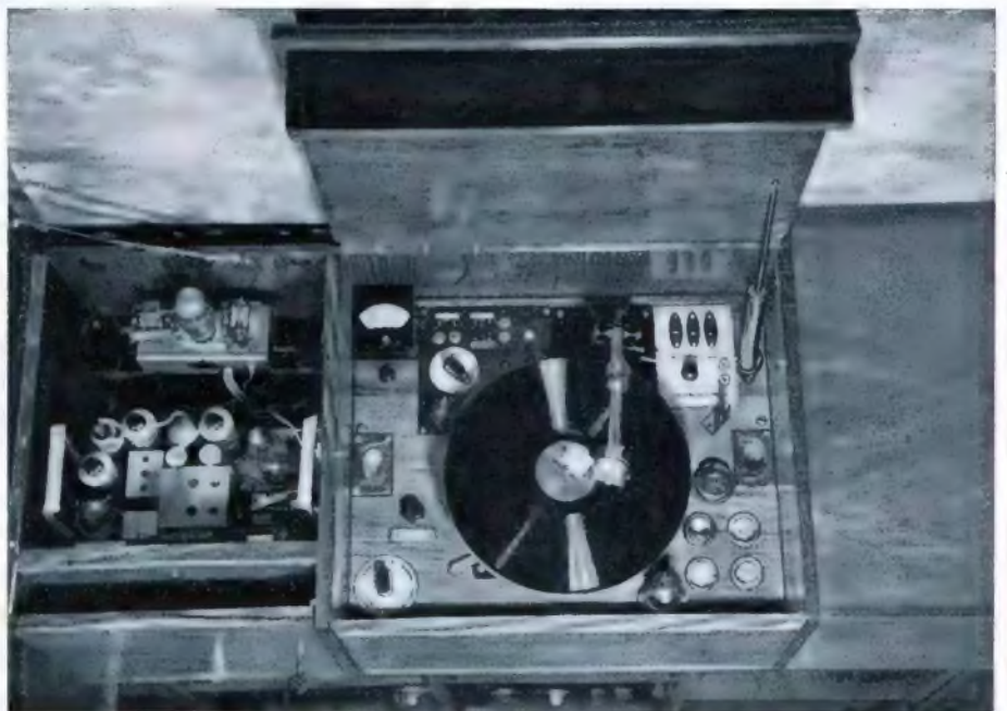
Blick von oben auf den Schallplattenteil. Außer den üblichen Schaltern und Umschaltern für Messungen und Versuche links vorn ein Universalwähler (Nockenschalter), der alle Umschaltungen vereint, welche für den Nur-Hörer in Frage kommen. Die Welle dieses Schalters ist 95 cm lang (!), wird zweimal im rechten Winkel geführt und ist teilweise sogar abgeschirmt. Der Schalter funktioniert — allen vorher geäußerten Bedenken zum Trotz — sehr gut! Der Deckel über dem Empfängerteil ist hochgeklappt, damit der hinter dem Superhet stehende Ortsender-Empfangsvoratz zu sehen ist.
