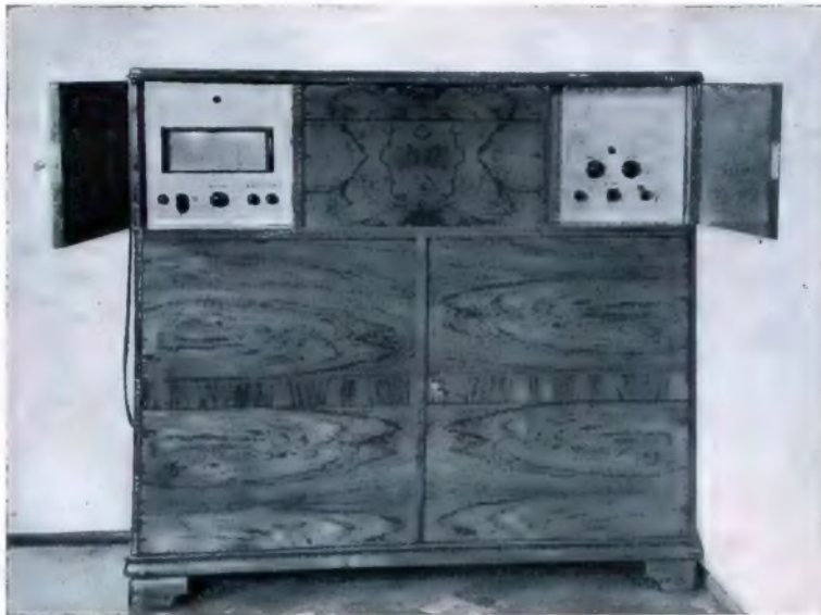
Die Truhe beim Rundfunkempfang. Die beiden Geräte sind durch Aluminiumplatten verdeckt, die mit ihren Bedienungsknöpfen 50 mm hinter den kleinen Türen liegen. Außerdem sind die Deckel über den Gestellen seitlich hochklappbar.
