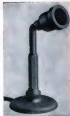
Bild 5. Tauchpulsmikrofon für rauesten Betrieb auf Bahnhöfen und dgl. (Lorenz).
