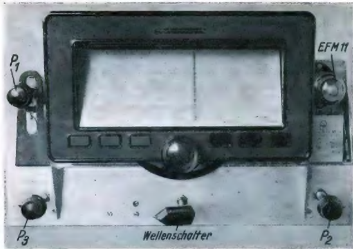
Frontansicht des Empfängers, die Anordnung der Bedienungsknöpfe zeigend. Rechts von der Frontkala befindet sich in gleicher Höhe wie P_1 die Abstimm-anzelgeröhre EFM 11. Die Antennenverlängerungsspule L J wird mit ihrer Befestigungs- spindel etwa 2 cm über dem Gestell montiert.
