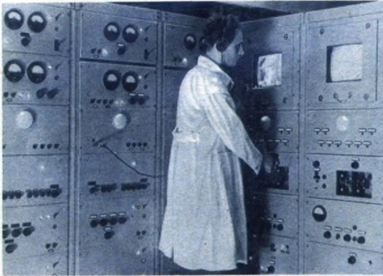
Oben: Die Verstärkergestelle für die Bildgeber und für das Bildabtafengerät der Bühne des Fernsehsenders Berlin. Zwei Braunsche Röhren gestatten die Überwachung des zum Mischpult gehenden Bildes.
