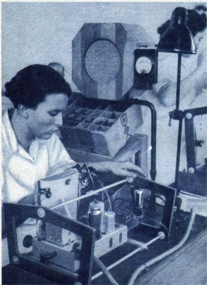
Empfänger-Fließband auf der Rundfunkausstellung: Das Sachswerk fabrizierte vor den Augen der Besucher einen Zweikreis-Empfänger. Unser Bild zeigt einen der Prüfplätze. (Aufnahme: Blunck)
