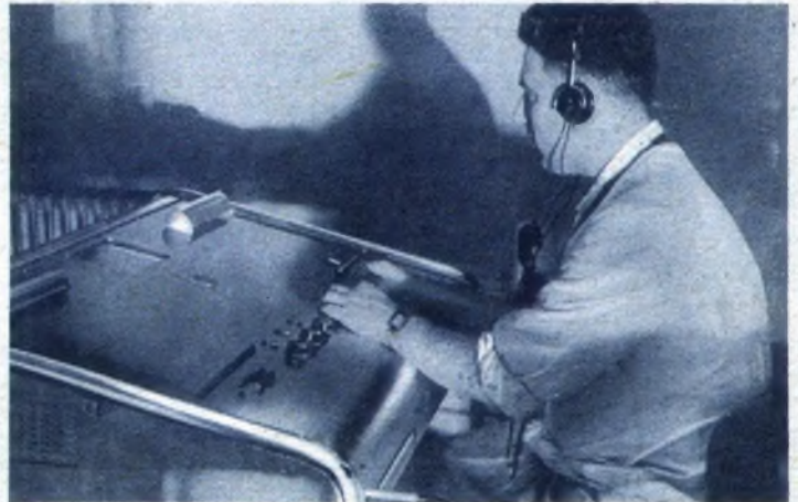
Im Regieraum der Fernseh Bühne des Fernsehsenders Berlin befinden sich mehrere Mischpulte, mit deren Hilfe die Überblendung vorgenommen wird. Die Braunschen Röhren, auf denen die Kontrollbilder der einzelnen Aufnahmegeräte und das zu sendende Mischbild erscheinen, sind auf dieser Aufnahme nicht zu sehen.
