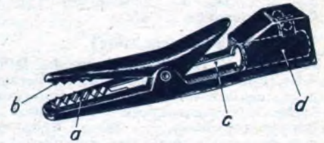
Eine ganz aus Isolierstoff bestehende Abgreifklemme. a Metallzähne, b Isolierstoffzähne, c Metall-Leitföhre, d Steckbuchse.
