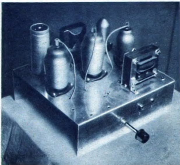
Das Bild zeigt den Zusatz-Kontrastheber in der Ansicht von oben. Obgleich das Gerät keineswegs eng aufgebaut wurde, nimmt es doch nur wenig Platz ein. Der kleine Knopf bedient den Eingangsgregler.
