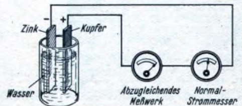
Bild 1. Der einfache Auf-bau des Kupfer-Zink-Ele-mentes mit den angechal-teten Instrumenten.
