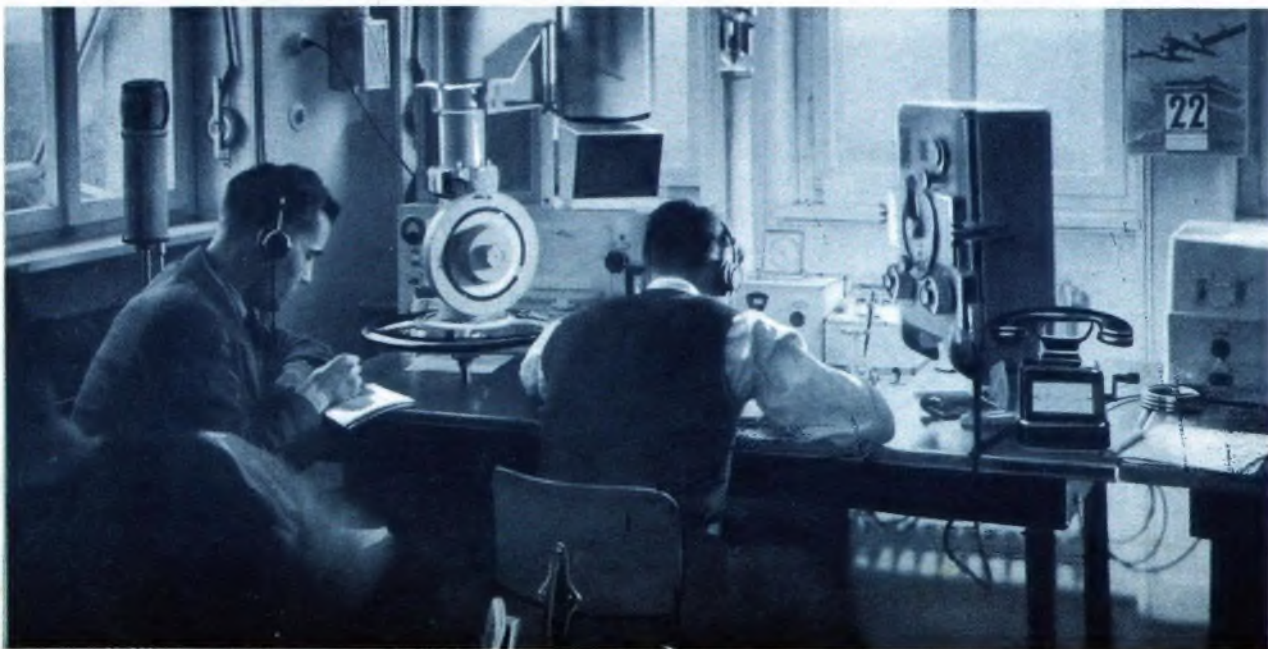
Arbeit an Telefunken-Peilgeräten in einer Luftfahrt-Peilstelle. Links: Impulsgerät, rechts: einfaches Peilgerät.
