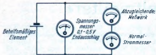
Bild 2. In dieser Schaltung können die elektrischen Werte eines Drehspul-Meßwerkes festgestellt werden.
