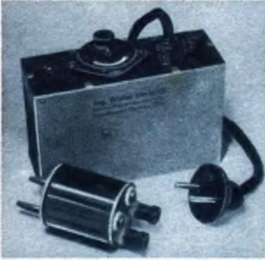
Links: MPA-Netzgerät (100-240 Volt, röhrenlos, völlig brummfrei, 4 Watt Leistungsverbrauch, Störstutzwicklung) und MPA-Steckzusatzelement. (Ing. Walter Herterich)
