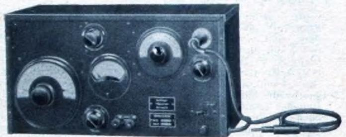
Empfänger-Prüfgenerator mit künstlicher Antenne. Spulensätze sind auswechselbar. (Siemens)
