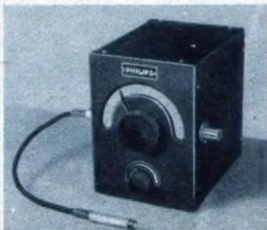
Frequenzmodulator zur Sichtarmachung von Abtimm-Kurven auf der Elektronenstrahlröhre. (Philips)
