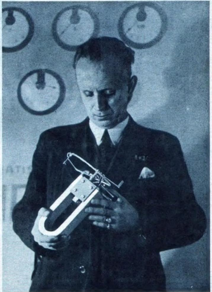
Das größte Drehpulley-System, das in der Meßgerätefabrik der AEG gebaut wird, gehört zu einem Tintenstrahlreiber.
