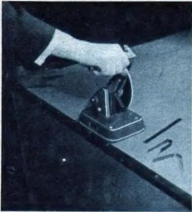
An diesem Federnprüfer werden Federbleche (z. B. für Wellenhalter) untersucht.
