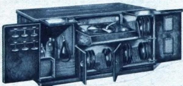
Für die Anpassung der einzelnen Tonabnehmer an den Verstärkereingang des Rundfunkgerätes sind zahlreiche elektromagnetische Tonabnehmer mit 3- bis 4stufigem Impedanzregler ausgerüstet, während für den Einbau des TO 1001 im Tonmöbel zusätzlich ein Übertrager zur Erhöhung der Ausgangsspannung und fast stets ein dreistufiges Nadelgeräuschfilter vorgesehen werden.
