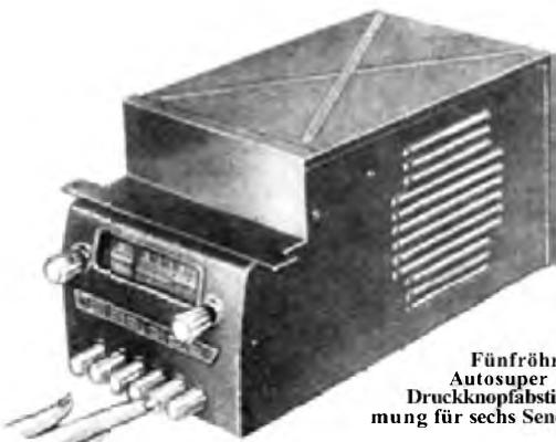
Fünfrohren-Autosuper mit Druckknopfabstimmung für sechs Sender.
