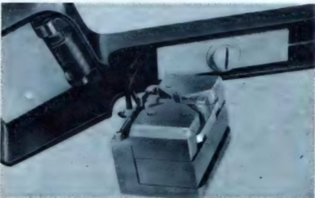
Tonabnehmer TO 1001, System herausgenommen. Man erkennt deutlich die auf Torsion beanspruchte Anker-Traverse. Links oben am Gehäuse die exzentrische Rolle, die den Saphir schützt, wenn man den Tonabnehmer versehentlich auf die Platte fallen läßt. (Werkbild: Telefunken)
