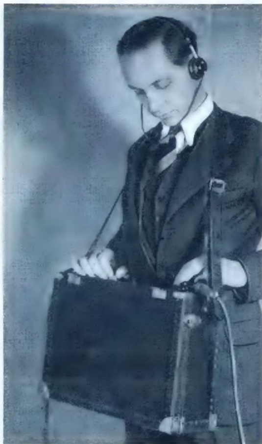
In diesem kleinen Koffer befindet sich der vollständige Aufnahmeverstärker für die Tonfilmaufnahme.
