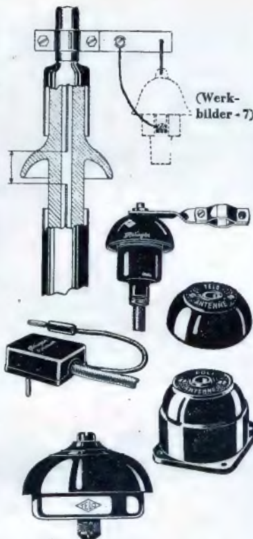
Neue Antennen-Bauteile. Von oben nach unten: Isolator der Kaparöhre-Antenne mit innenliegender Grobfunkstrecke - Helioantenne - Empfängerübertrager - Übertrager der Poli-Allwellantenne.
