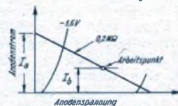
Dieses Anodenspannungs-Anodenstrom-Kennlinienbild hilft uns bei der Lösung unserer Aufgabe.
