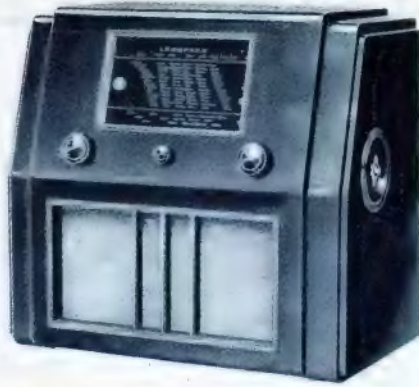
Lumophon WD 489, ein dreikreisiger Spitzenuperhet mit zwei Lautsprechern.
