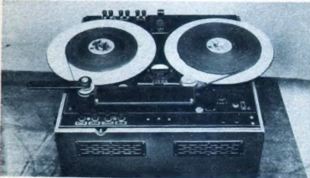
Das AEG-Magnetophon. In dem länglichen Kasten, durch den das mit Eisenpulver verfehene Papierband läuft, befinden sich die Aufnahme-, Wiedergabe- und Lötlmagnete.
