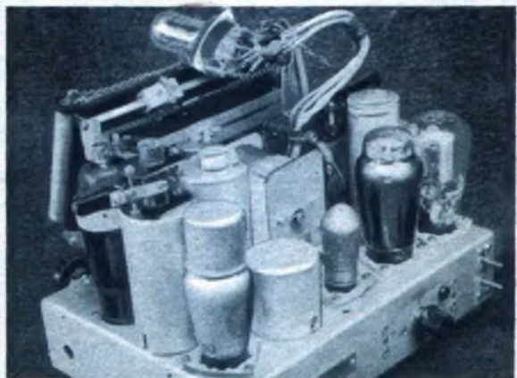
Baumfellen von gestern und heute: Der „Billige Vierer“ und der „FUNKSCHAU-Garant“ Damals schon die Zwillingsboden-Form, jedoch Holz und Hartgummi als Baufstoffe.
