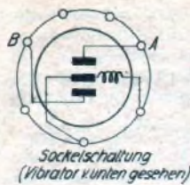
Links: Die Sockelschaltung des Vibrators.
