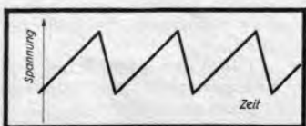
Abb. 3. Der zeitliche Verlauf einer KippSchwingung.
