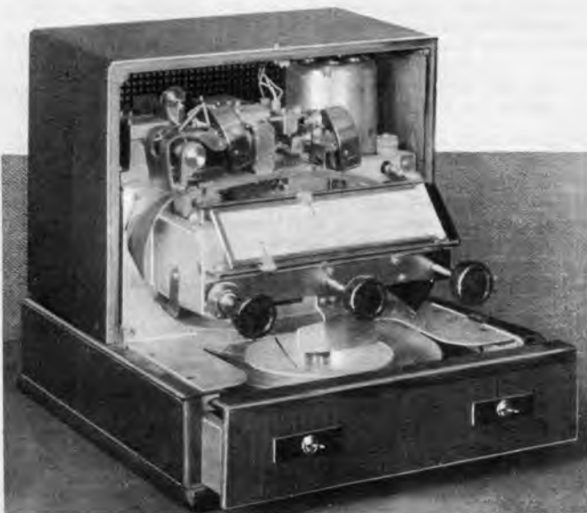
Abb. 1. Das Tefiphon (geöffnet), ein neuzeitliches Aufnahme- und Wiedergabegerät für vielfältige Aufnahme. Werkaufn. Dr. Daniel & Co.
