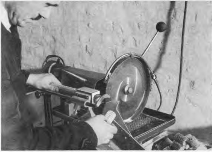
1. Ein Elektrolytblock besteht im wesentlichen aus dem Elektrolyten, dem Kern, dem Gehäuse und zwei Ablußdeckeln. Das Bild zeigt eine Kreissäge, die von einer Aluminiumstange den sternartig geformten Kern auf die richtige Länge abschneidet.
