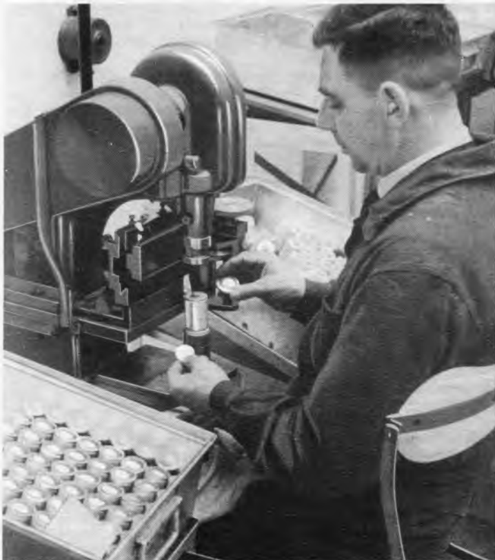
4. Der sternartige Kern mit feinem angeieteten Bakelitdeckel wird nun in das Aluminiumgehäuse eingefalzt und damit unverrückbar mit ihm verbunden.
