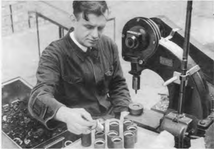
2. Nachdem der Kern einen Ätzprozeß durchgemacht hat und nach sorgfältigem Abkochen wird der Bakelitfuß mit Hilfe einer Presse aufgepreßt. Außerdem wird ihm fein Gehäuse zugeteilt.
