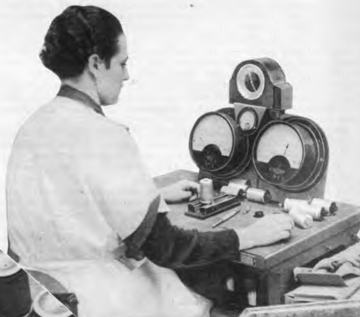
6. Nachdem die Kondensatoren noch einmal nachformiert wurden, werden sie auf Kapazität und Resistenz hin genau geprüft.
