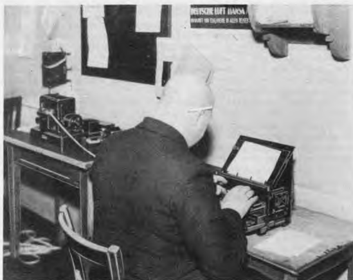
Ein Schnelltelegraphie-Sender ist nicht hand-, sondern maschinengesteuert. Die Maschineneinstellung erfolgt durch einen entsprechend gelochten Papierstreifen. Unter Bild zeigt die Schreibmaschine, auf der vom Klartext weg die Lochung von Hand vorgenommen wird. Werkaufnahme Telefunken.
