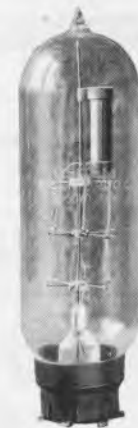
Die neue Eisenurdoxlampe. Im oberen Teil der Urdoxwiderstand, darunter der Eisenwiderstand. Die Röhre hat bereits den achtpoligen stiftlosen Sockel. Aufnahme vom Verfasser.
