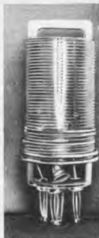
Rechts: Abb. 5. Der Antennenkopplungskondensator befindet sich innerhalb des Spulenkörpers.
