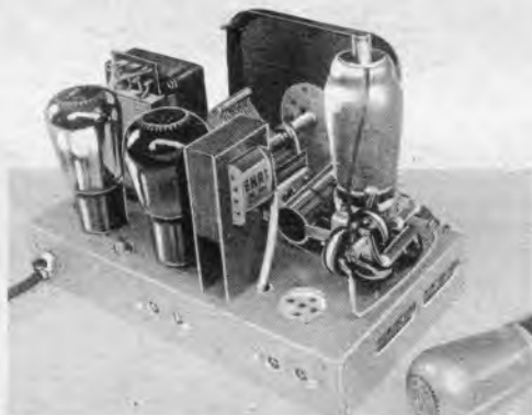
Unmittelbar am Sockel der Mifchröhre befinden sich die Ofzillatorspule und verschiedene Teile. Vergleiche das Bild auf der nächsten Seite.
