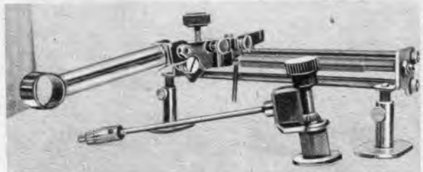
Die einfache Einrichtung für den Transport der Schneidedose quer zur Schallplatte. (Aufnahme Radio-Huppert)
