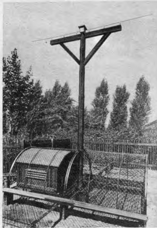
Der Voreinflugszeichenfender mit feiner Dipolantenne.
