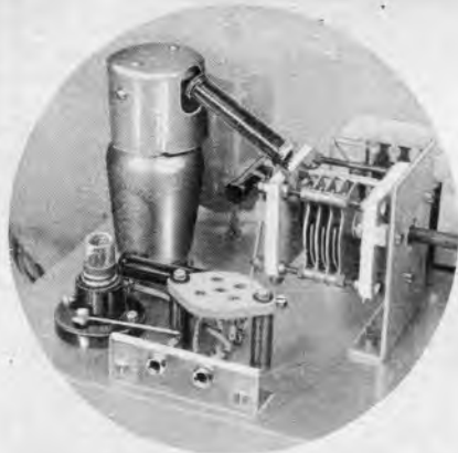
Abb. 5. Der Audionteil für sich. Neben der Röhre die Glühlampe, davor die Fassung für die Steckspulen und der Antennen- und Erdanschluß. Zwischen Röhre und Abstimmung der Gitterkondensator.
