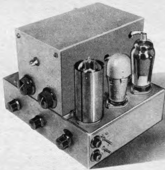
Der Verstärker ist ähnlich aufgebaut wie der kürzliche Wechselstromverstärker „Goldene Kehle“. Vorne im Blechmantel die Eifen-Urdox-Widerstands-lampe. Die Bedienungsknöpfe: Oben Lautstärke- und Klangregler, unten Umschalter von Rundfunkwiedergabe auf Tonabnehmer oder Mikrophon, Abstimmung, Ein-Aushalter.
