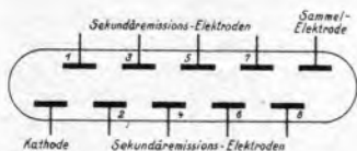
Abb. 1. Eine stark vereinfachte Darstellung einer Vervielfacherröhre.
