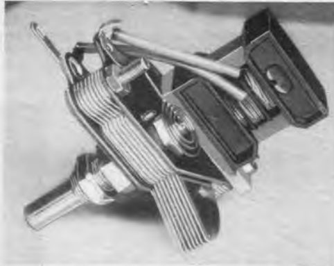
Der kleine Sperrkreis in Schaltung und Ansicht. Die Spule ist unmittelbar am Drehko befestigt. (Aufn. vom Verfaßer)
