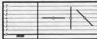
Abb. 6. Links ein ungestörtes Senderfeld. Der dicke Strich unten deutet die Erdoberfläche an. Die dünnen Striche darüber in gleichen Abständen sind Spannungslinien. Die eingetragenen Ziffern bringen Größen von Spannungen zum Ausdruck. Im rechten Teil des Bildes sind drei Antennen in das Senderfeld eingezeichnet. Unter Vernachlässigung der verzerrenden Wirkung ergeben alle drei Antennen gleiche Spannungswerte. Würden wir die verzerrende Wirkung der Antennen berücksichtigen, so würde die Spannungszahl der mittleren Antenne am geringsten und die Spannungszahl der mittleren Antenne nur etwas kleiner ausfallen, als die der waagerechten Antenne.
