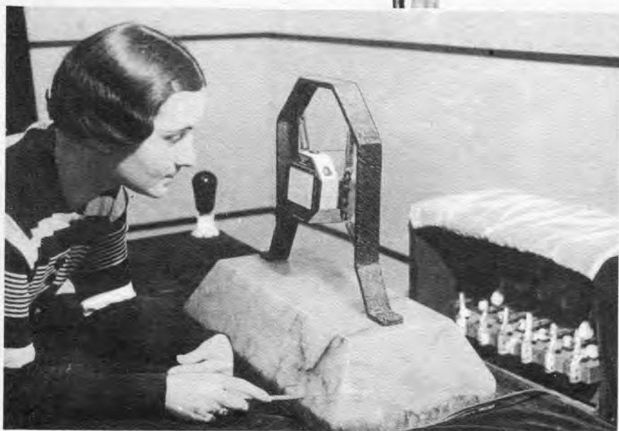
Rechts: Das Marconi-Bändchen-Mikrophon, ein Mikrophon hervorragender Richtwirkung. Photo B.B.C. London.
