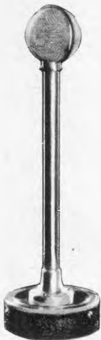
Links: Ein englisches Kristallmikrophon. Der Vorverstärker befindet sich im Fuß des Mikrophones. Photo B.B.C. London.
