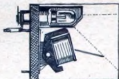
Links übereinander: Ein Schattenzeiger; Abstimmanzeiger mit Gehäuse. Wir erkennen an der Vorderseite des Abstimmanzeigers den Ausschnitt, der durch das Lampchen beleuchtet wird. Darunter die Spule und der Zeiger des Meßsystems. Wir erkennen auch den Magneten, der die Spule teilweise umgibt. Das Lampengehäuse besitzt eine schützartige Öffnung.
