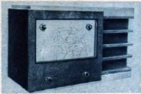
Vier-Röhren-Superhet mit geographischer Stations-Skala „Arel“. Preis ca. RM. 220.—. (Werkphoto)
