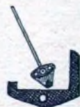
Die beiden Magnete eines Abstimmanzeigers. Der L-förmige Magnet ist fest angeordnet. Der kleine ellipsenförmige Magnet steht mit dem Zeiger in Verbindung. Zwei kleine Lötchen dienen zur Gewichtsverminderung. Der genaue Gewichtsausgleich erfolgt durch das dunkelfraufierte kleine Metallstückchen, das auf das Zeigerblech aufgeklebt ist.
