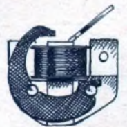
Meßsystem eines mit Zeiger ausgestatteten Abstimmanzeigers. Wir erkennen deutlich die Spule und den etwa halbkreisförmigen Dauermagneten. Spule und Magnet sind auf einem Messingblech befestigt, das auch das Zeigerlager hält.
