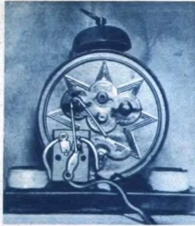
Links: Die Gesamtanordnung. Unten der Schalter, der vom Weckeraufzug aus über eine Gabel in Tätigkeit gesetzt wird. Oben: Die Klemme zur Befestigung der Gabel, darunter: Die einfache Schaltung der Schaltuhr. Aufnahme vom Verfasser.
