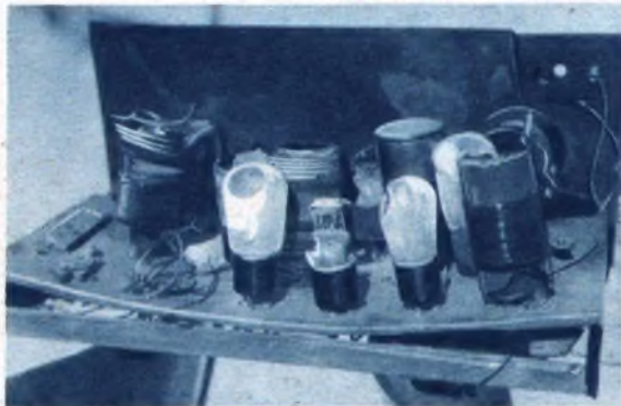
Da hat der Blitz eingeschlagen. Ein Wunder, daß noch so viel übrig blieb. Daher: Sichert den Empfänger durch einwandfreien Blitzschutz. (Für Photos aus unserem Leserkreis, die wir hier veröffentlichen, honorieren wir RM. 1.—. Wer hat gute und interessante Bilder?)
