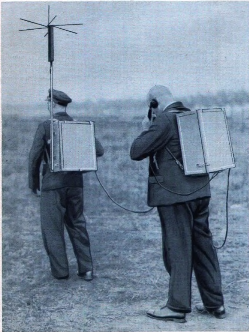
Modernste Rundfunkreportage: Der eine Mann trägt den Sender mit der schirmförmigen Antenne, der andere den Batteriekasten. Selbstredend kann sich der Reporter durch ein ge- sondertes Mikrofon noch freibeweglich anschließen. Werkphoto Telefunken.
