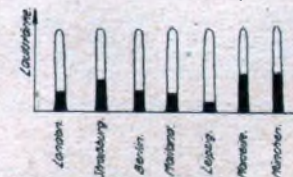
4 Lautstärkeverhältnisse bei einem Gerät mit Lautstärkeausgleich und autom. Krachtöter.
