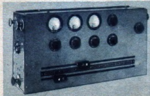
Ein Flugzeugempfänger, der für Empfang von Signalen des neuen Magnetron-Ultrakurzwellenfenders besonders entwickelt wurde
