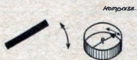
Abb. 2. Schwingt man den Magneten hin und her, so schwingt auch die Magnetnadel: Übertragung einfacher magnetischer Schwingungen
