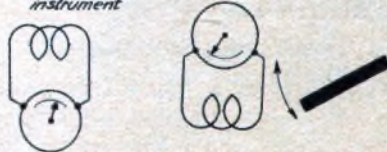
Abb. 4. Durchfließt die Spule Wechselstrom, so schwingt der Zeiger des Meß-Instrumentes
