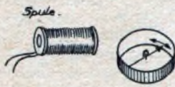
Abb. 3. Fließt durch die Spule Wechselstrom, so erhalten wir auf die Magnetnadel die gleiche Wirkung wie in Abb. 2
