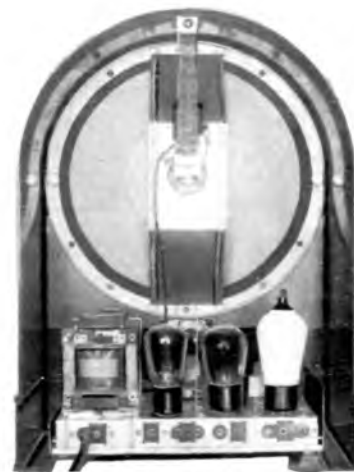
Blick ins Innere des Wechselstrom-Zweiers, mit Lautsprecher kombiniert.
