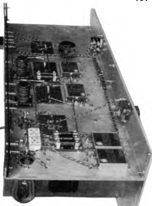
gleich aus einem Stück zu biegen. Dieses Biegen macht jeder Spengler für wenig Geld. Zur Not kann man das 1 mm starke Aluminiumblech auch über die Tischkante biegen. Die Befestigung der drei innen liegenden Trennwände geschieht am bequemsten dadurch, daß wir diese Bleche am Ende gleichfalls abbiegen, und dann den abgeboigten Rand mittels Schrauben und Muttern an der Hinterwand anschrauben.
