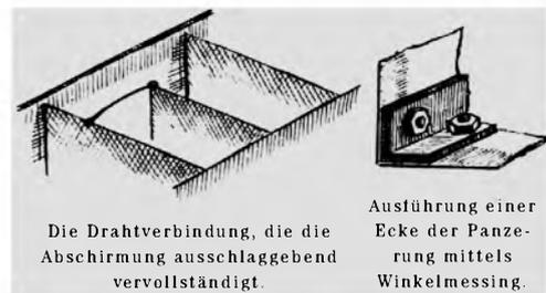
Die Drahtverbindung, die die Abschirmung ausschlaggebend vervollständigt.
