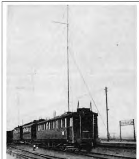
Die rollende Funkstation. Dieser Funkzug dient dazu, Verbindung aufzunehmen mit festen Empfangsstationen im Falle von Bauarbeiten oder Unglücksfällen. Die Masten sind in wenigen Minuten ausgefahren.
