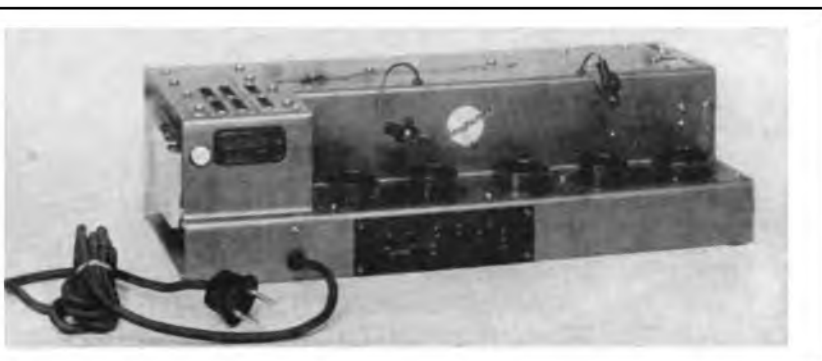
Abb. 3. Das Chassis ist als völlig geschlossene Einheit und absolut berührungssicher ausgeführt.
