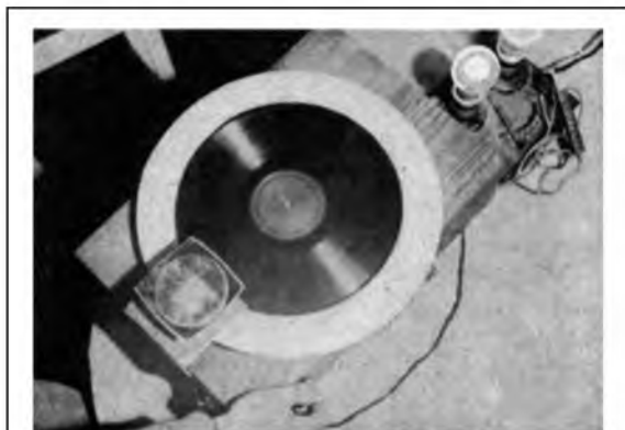
Eine Fernsehapparatur mit einfachsten Hilfsmitteln Zwischen Schallplatten liegt die Nipkowscheibe.
