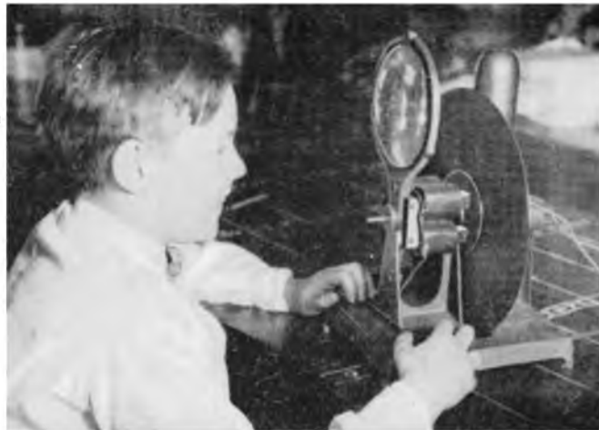
Gebaut aus einem Fernsehbakasten nach dem amerikanischen Jenkins-System.
