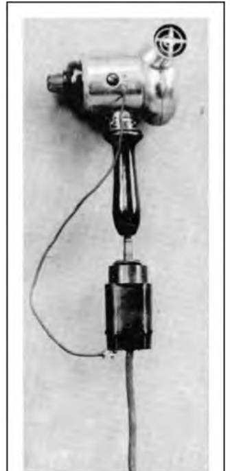
Diese Heißluftdusche ist mit einem Siemens-Zwischenstecker entstört. Man sieht deutlich das Kabel, das das Gehäuse mit den Entstörungskondensatoren verbindet.
