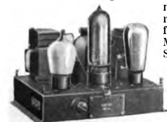
Neufeldt & Kuhnke bringt einen Kraftverstärker nach dem interessanten Loftin-White-Prinzip.
