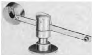
Das Vorschubgetriebe, das die A.E.G. verwendet, verblüfft durch seine geniale Einfachheit.
