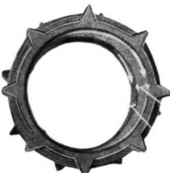
Abb 11 Bei Langwellenspulen darf man sich „wilde Wicklung“ leisten; hier wurde Rippenrohr als Spulenkorper verwendet, in das Nuten eingefeilt sind.
